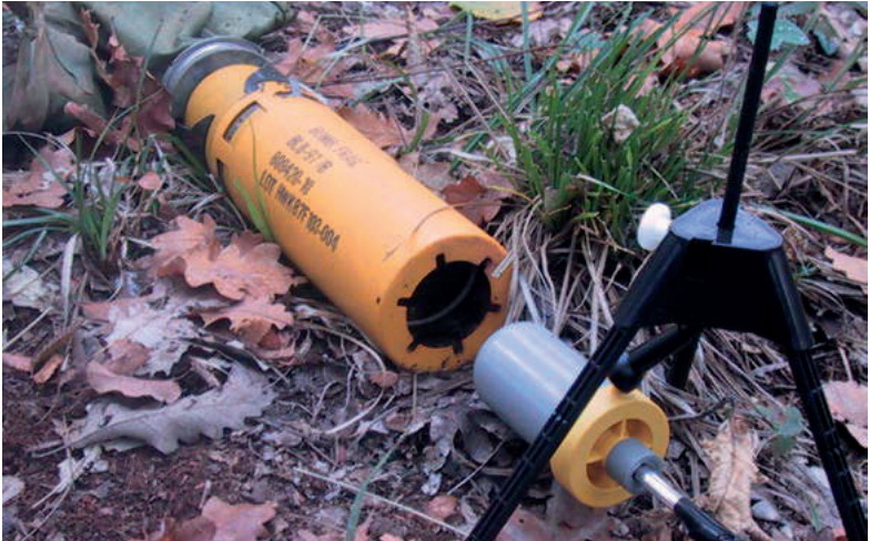
Smaltimento sicuro degli ordigni inesplosi: grazie al sistema SM EOD sviluppato in Svizzera, ordigni inesplosi possono essere distrutti senza contatto (C) DDPS
