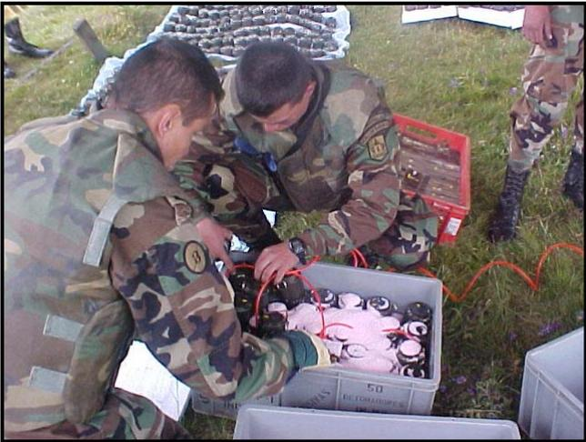
**EXPLOSIVO UTILIZADO (ANFO Y CORDÓN DETONANTE) PARA LA DESTRUCCIÓN DE LAS MINAS**
